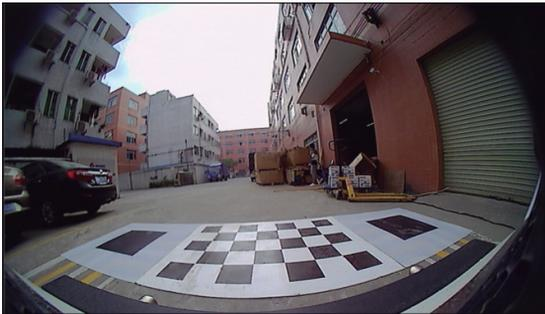
**Câmera Esquerda:** Fixada na parte inferior do retrovisor esquerdo (motorista).
