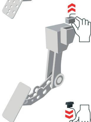
**B** O chicote possui duas extremidades: um plug macho e um plug fêmea. Conecte primeiramente a extremidade fêmea do chicote do Kit ShiftPower no pedal, e em seguida a extremidade macho no cabo que foi retirado do pedal original.
