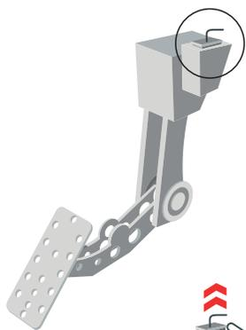
**A** Localize o conector original no pedal do acelerador e retire-o.
