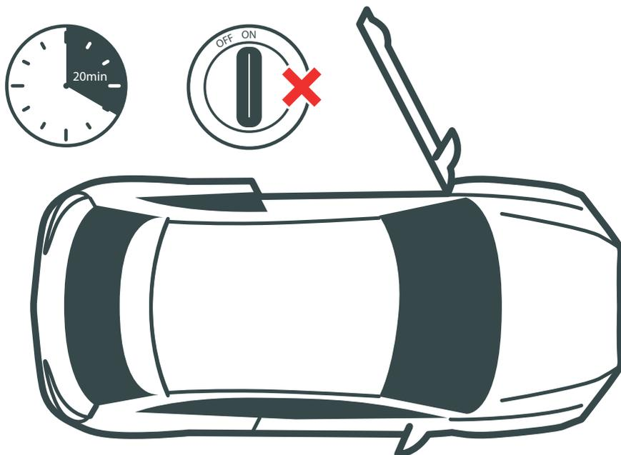
Com a porta do veículo aberta, aguarde por volta de 20 minutos antes de iniciar a instalação do ShiftPower.
