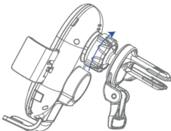
Ajuste a trava giratória de fixação até obter um posicionamento firme
