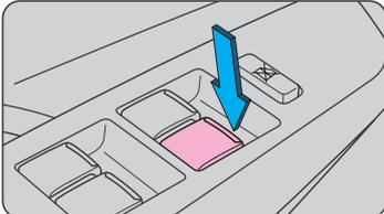
2. Ligue o veículo e mantenha o botão pressionado por mais 5 segundos após a abertura total do vidro para iniciar a calibração. Ao iniciar, será emitido 2 Bips indicando que o processo de calibração foi iniciado;
