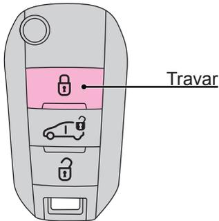
Para fazer o fechamento dos vidros, pressione a tecla Travar do controle remoto para fechar o veículo e automaticamente subir os vidros.
